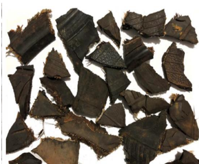
Рисунок 3 – Щебень из переработанных шин
